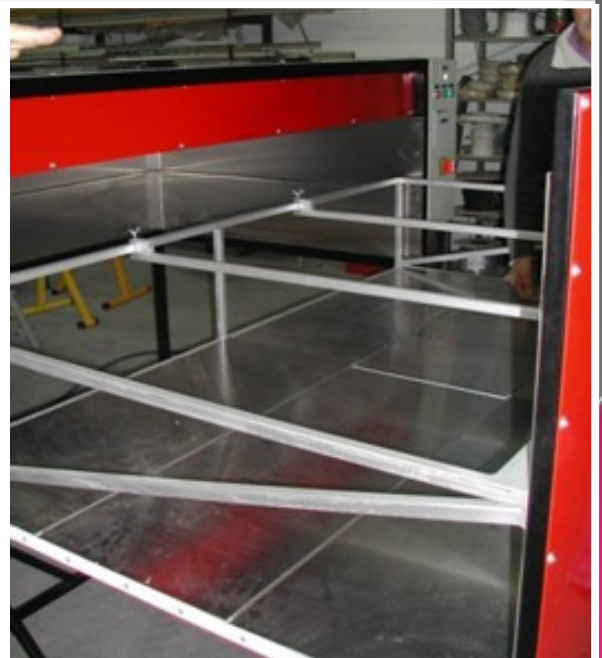
Chariot ouvert avec barres de thermoformage réglables en écartement
